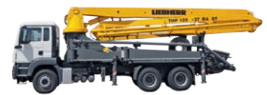
37 R4 ST 36,8 m alcance vertical 32,8 m alcance horizontal
