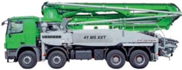
41 M5 XXT 40,5 m alcance vertical 36,5 m alcance horizontal
