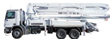
37 Z4 ST 36,8 m alcance vertical 32,8 m alcance horizontal
