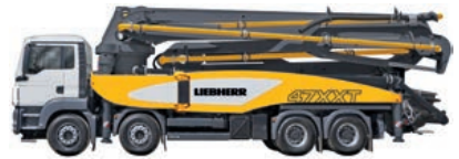
47 M5 XXT 46,2 m alcance vertical 42,2 m alcance horizontal
