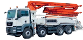
32 Z5 XXT 31,7 m alcance vertical 27,7 m alcance horizontal
