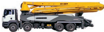
43 R4 XXT 42,1 m alcance vertical 38,1 m alcance horizontal
