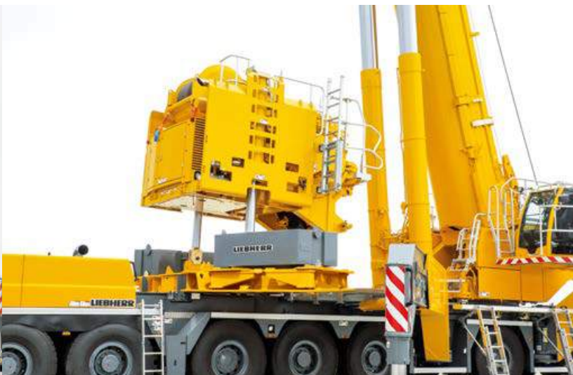
7 El cilindro de bastidor de contrapesos se fija sobre la placa base de contrapesos
