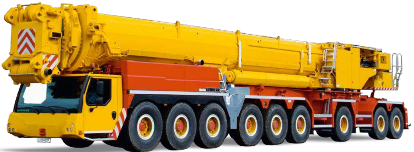
Peso total de 99 t con una carga por eje de 11 t sin estabilizadores
