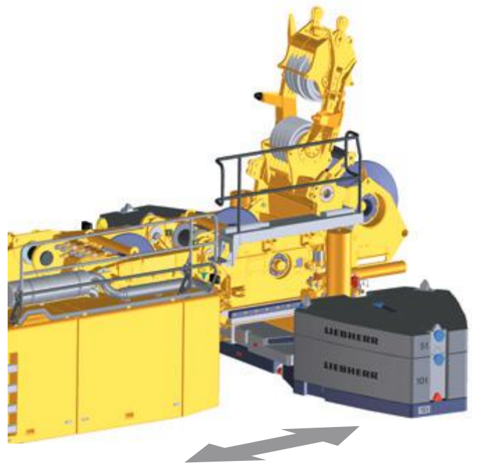
Trabajo con plumin abatible, radio de contrapeso 5,6 m ó 6,6 m
