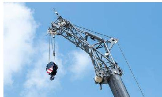
Plumín doble con ajuste hidráulico (0° hasta 40°)
