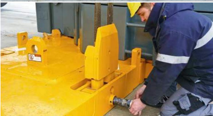
Embulonamiento fácil de la placa base con el dispositivo de sujeción de contrapeso
