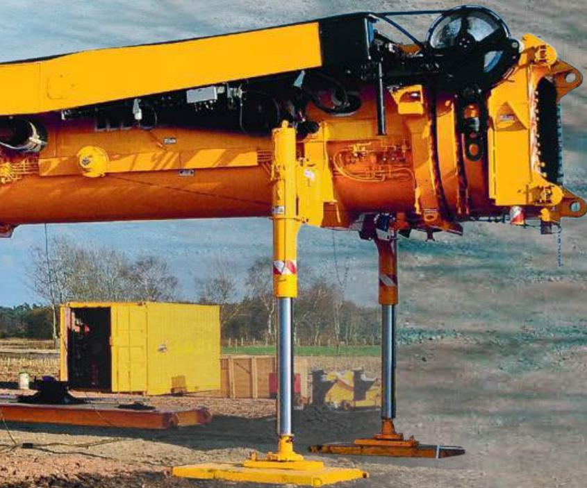
El montaje de la pluma en la obra sucede opcionalmente sin grúa auxiliar. Con cuatro cilindros de apoyo especiales la pluma se apoya de tal manera que se puede retirar la góndola y colocar el chasis de la LTM 11200-9.1 debajo de la pluma dando marcha atrás o bien hacia adelante. La pluma se puede montar con pocas maniobras en el chasis.
