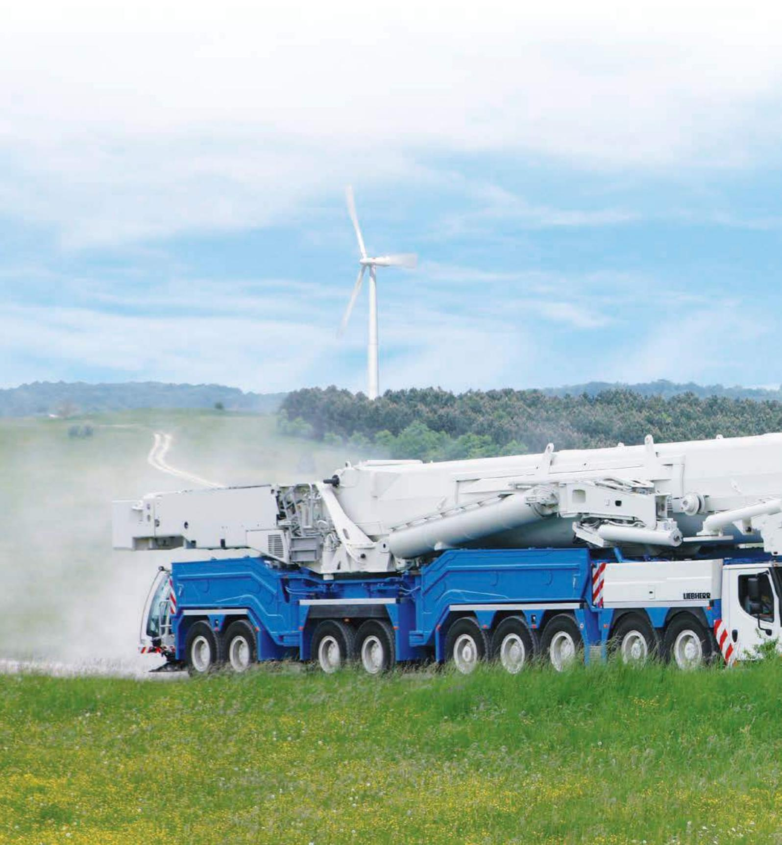
La LTM 11200-9.1 con una capacidad de carga de 1.200 t es la grúa móvil telescópica más potente en el mercado, y ofrece la pluma telescópica más larga del mundo. Aumentos considerables de capacidad de carga se consiguen con el arriostamiento Y. Tiempos de montaje cortos, una extraordinaria capacidad de maniobra así como un elevado nivel de confort y equipamiento de seguridad son características destacables de la grúa móvil LTM 11200-9.1 de Liebherr.
