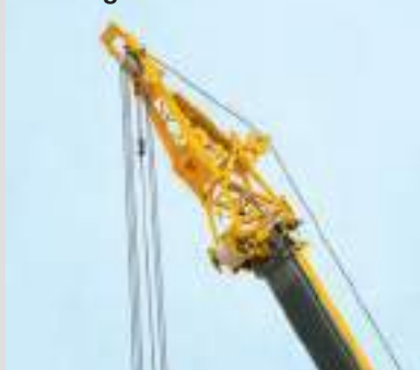
Plumín de montaje de 3,2 m de longitud
