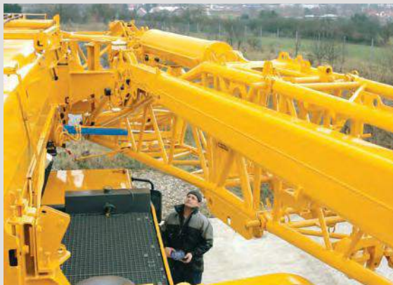
Ayuda de montaje hidráulica para el montaje del plumín lateral con el BTT
