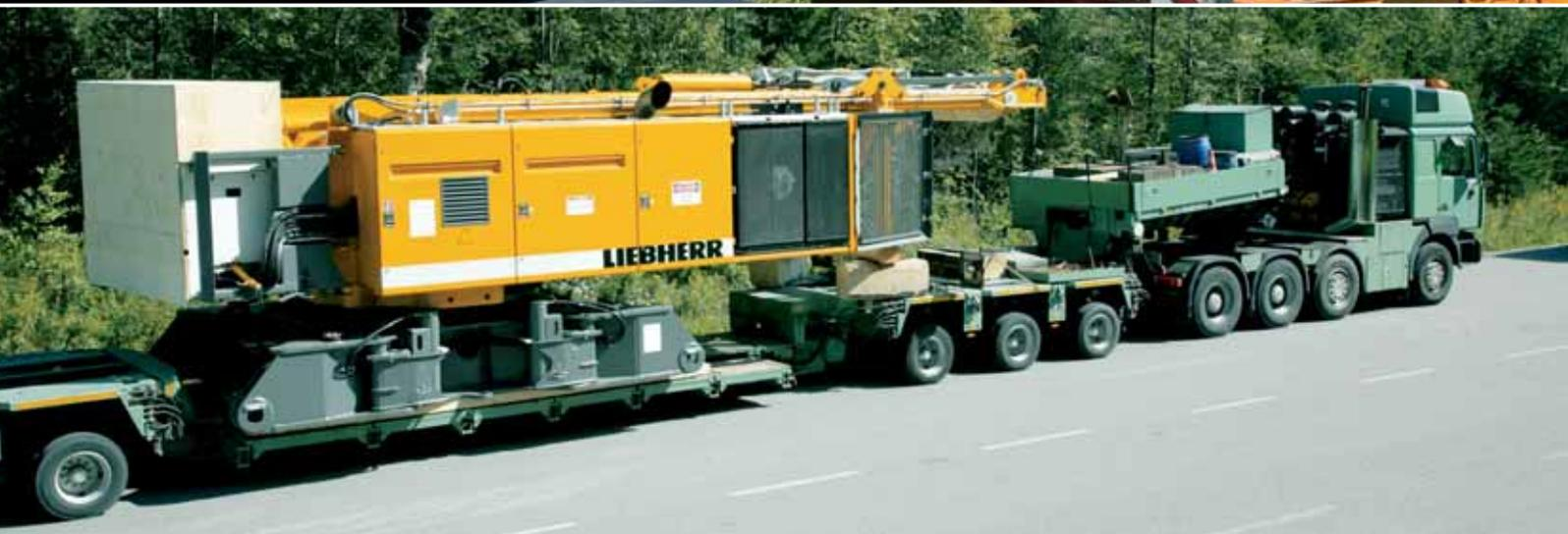
Para disminuir el volumen de transporte los tramos de plumín se pueden insertar dentro de los tramos de pluma principal. Las placas de contrapeso se pueden guardar debido a su poca altura bajo los tramos de pluma. Todas las tirantas y los bulones se quedan en los soportes que se han diseñado especialmente para el transporte.
