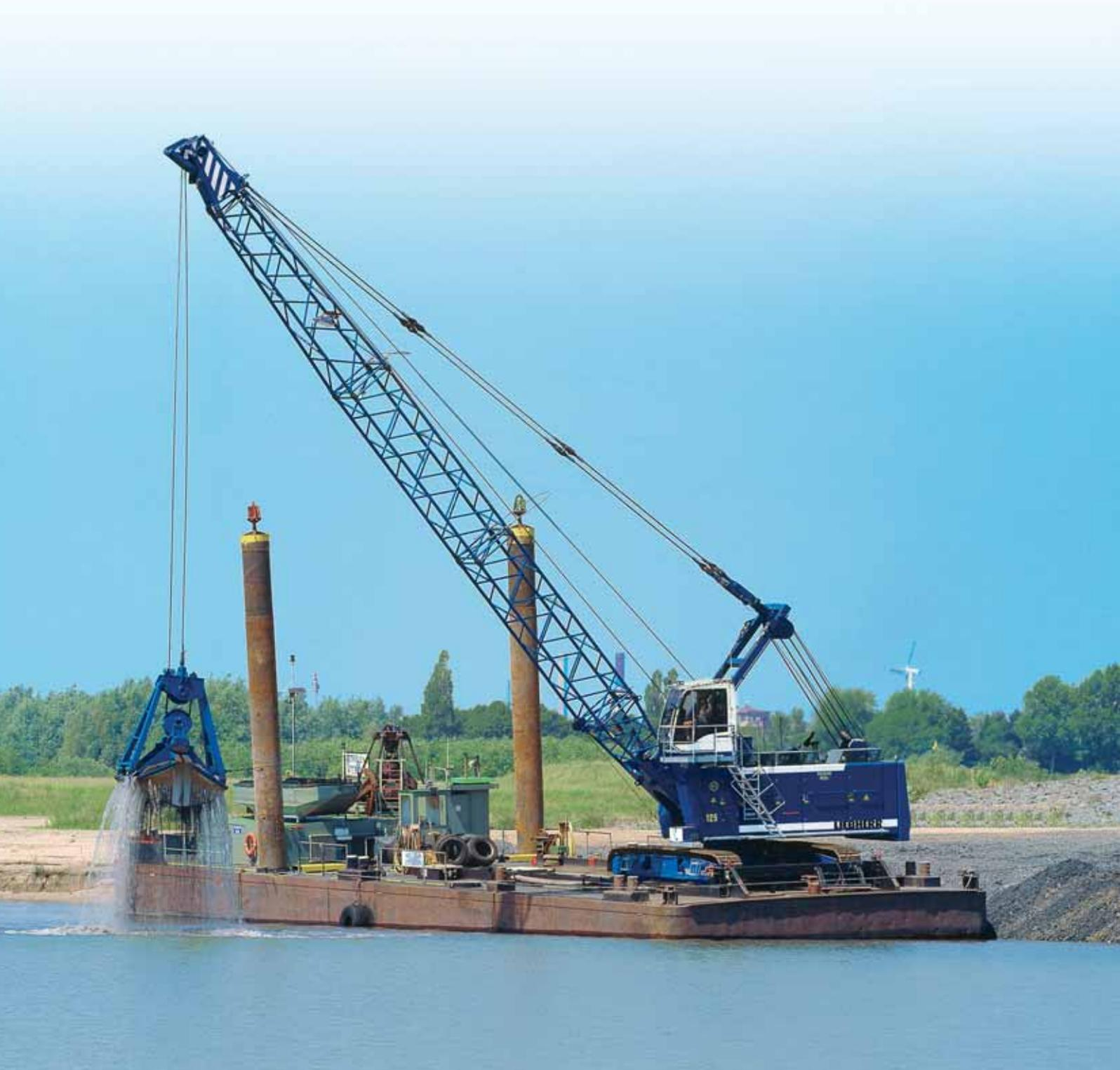
Frenos de caída libre hidráulicos permiten a la hora de trabajar con cucharas de pantallas un manejo preciso por ejemplo para vaciar directamente sobre un camión. Los joysticks multifunción contribuyen al manejo preciso de la cuchara. En estos joysticks están integradas todas las funciones necesarias para la operación, así como la aceleración del motor. El gruísta se puede concentrar plenamente en la zona de trabajo.
