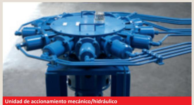
Unidad de accionamiento mecánico/hidráulico
