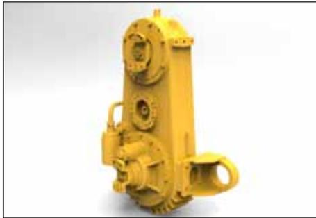
La caja de transferencia con diferenciales entre ejes proporciona un par igual a cada eje cuando la tracción es favorable. Cuando las condiciones se deterioran, el bloqueo del diferencial se acciona automáticamente para proporcionar par a los neumáticos que pueden usarlo mejor.
