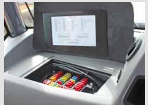
Una central de carga dentro de la cabina simplifica el reemplazo de los fusibles. Una menor cantidad de relés, conectores y arneses implica mayor fiabilidad.
