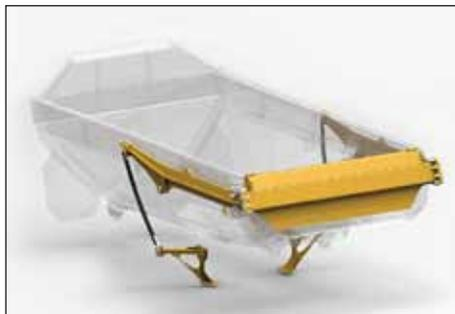
Un portón trasero está disponible como opción para una mejor retención del material. El portón se abre a medida que el volquete se levanta para su descarga. Las tiras de acero templado mantienen un sellado positivo a lo largo del transporte, asegurando una mínima pérdida de material.
