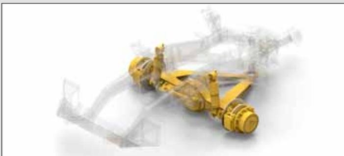
Para una cómoda productividad, la regulación de la suspensión delantera ayuda a minimizar la vibración, mientras un asiento con suspensión de categoría superior reduce el balanceo que se experimenta a menudo en la conducción por pistas.
