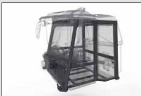
Nuestras silenciosas cabinas de operador están certificadas ROPS/FOPS con un asiento para el operador con suspensión neumática por aire. Tanto el asiento del operador como el del acompañante tienen cinturones retráctiles con bloqueadores automáticos.
