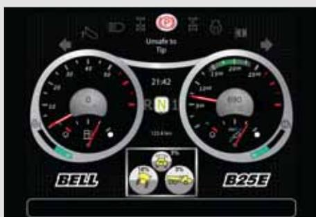
La incorporación de un sensor de caída y vuelco en el vehículo impide accionar el volquete si el camión se encuentra en una posición insegura.
