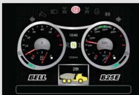
El pesaje a bordo le presenta al operador información en tiempo real sobre la carga útil mientras la máquina está siendo cargada. Un modo "restricción de la velocidad" puede también ser activado si la máquina está siendo significativamente sobrecargada.
