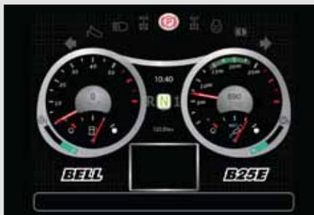
Un monitor a color de 10" de fácil manejo ofrece información vital sobre el trabajo, alertas de seguridad, informes de diagnóstico detallados y parámetros de funcionamiento del volquete.
