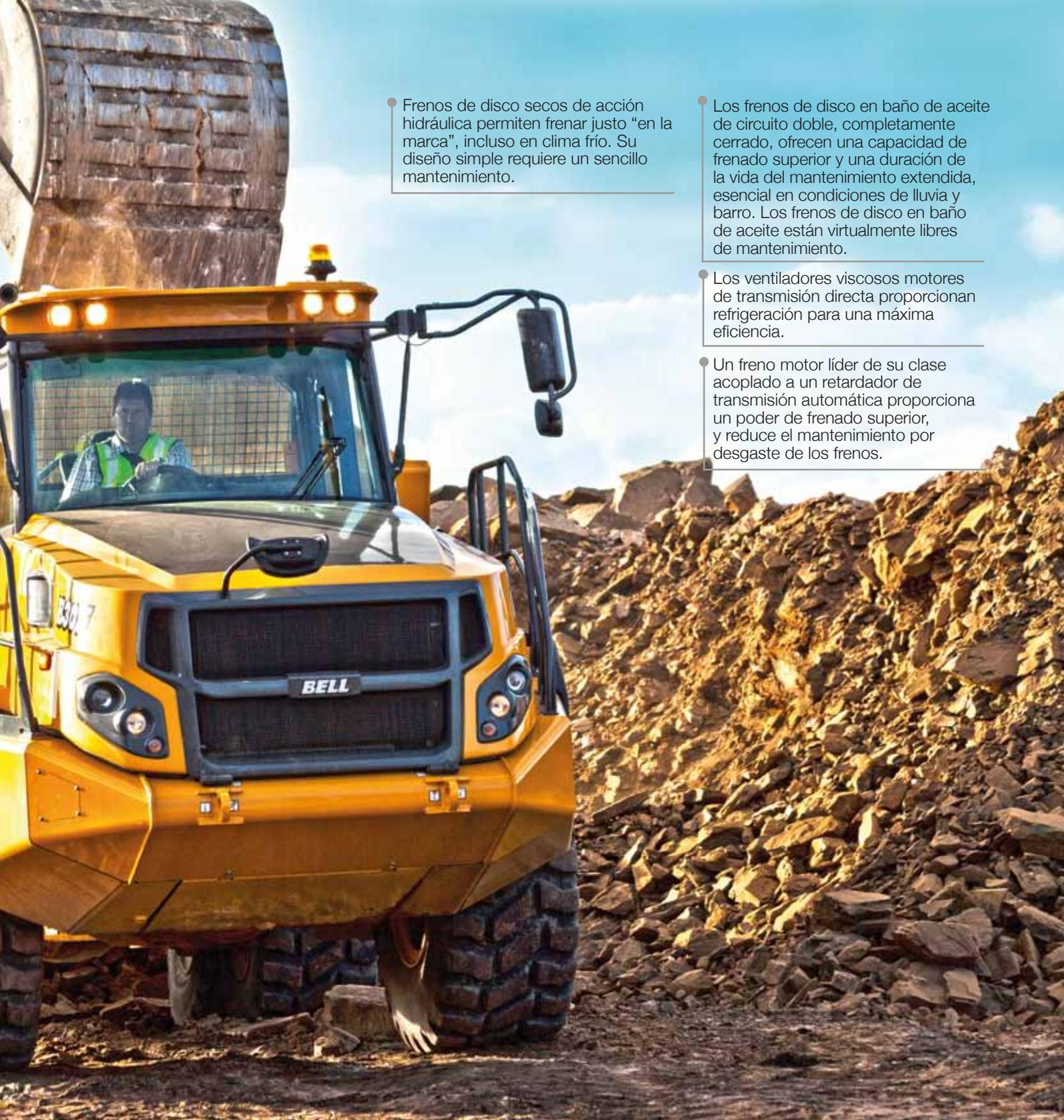
● Frenos de disco secos de acción hidráulica permiten frenar justo “en la marca”, incluso en clima frío. Su diseño simple requiere un sencillo mantenimiento.
