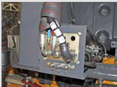
Los puertos de prueba de fácil acceso permiten a los técnicos detectar y resolver los problemas de forma más rápida.
