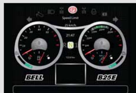
El control programable de velocidad máxima, que puede ser accionado para un conductor u obra en particular, permite al vehículo desacelerar automáticamente, y aplicar el retardador para evitar altas velocidades en el lugar de trabajo.
