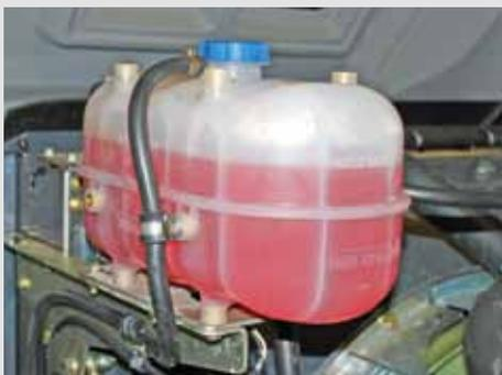
Tanques transparentes para fluidos e indicadores a la vista le permiten verificar los niveles de fluido de un solo vistazo.
