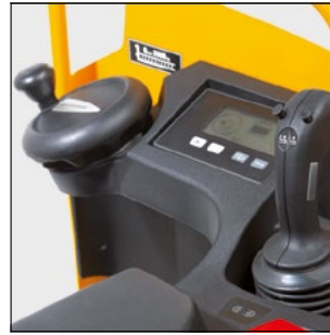
Manipulación de todas las funciones de marcha e hidráulica con la palanca multifunciones en ESE 220/320
