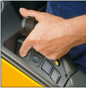
ESE 120: Elementos de manejo para la regulación de la velocidad de marcha y la función de elevación
