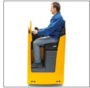
Posición de asiento confortable con placa de fondo regulable en altura
