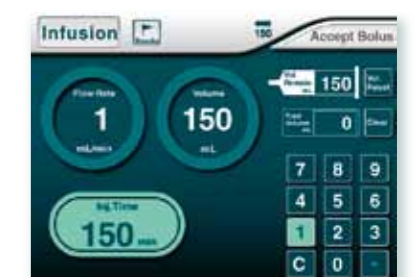
Pantalla de configuración del modo de infusión
