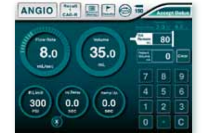
Pantalla de configuración del modo de angiografía
