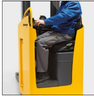
Posición de asiento confortable con placa de fondo regulable en altura
