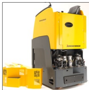
Grupos fácilmente accesibles gracias a cubiertas abatibles
