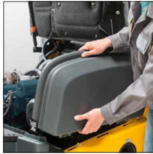
Piezas laterales desmontables fácilmente y sin herramientas.
